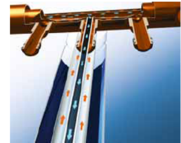
Dettaglio: scambio termico all'interno del collettore
